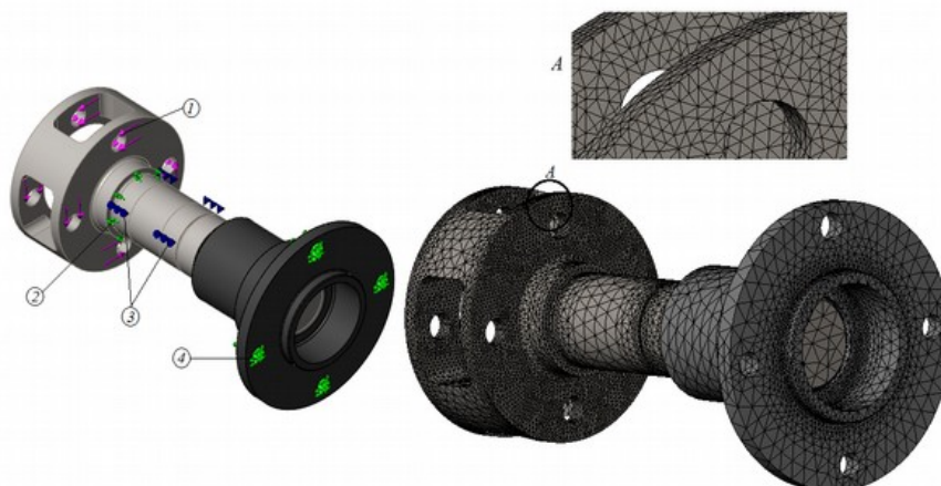
Рисунок 2. Конечно-элементная модель водила тихоходного планетарного ряда мотор-редуктора
