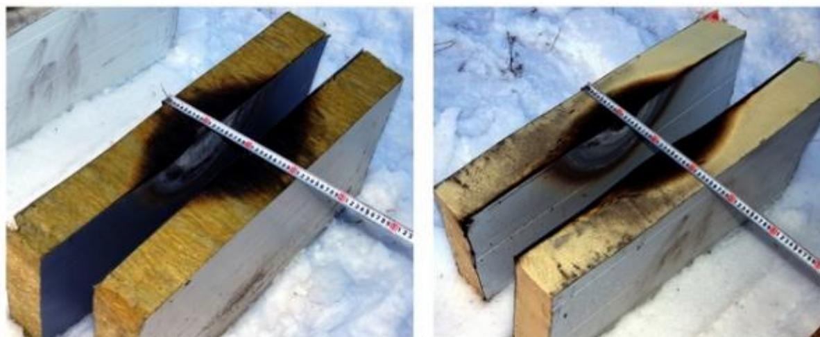
Рисунок 3 – Результаты огневых испытаний точечным источником пламени. Слева – мат из базальтовой минеральной ваты, справа – PIR-плита
