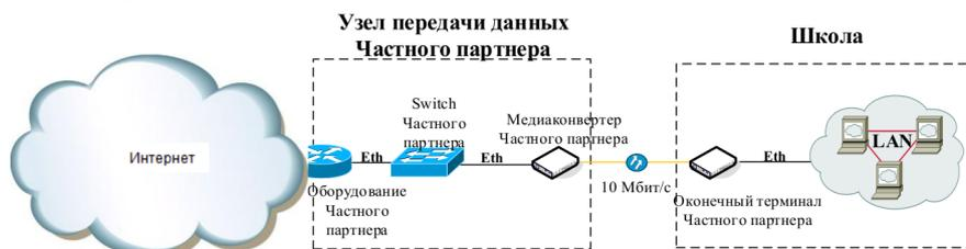
*Рисунок 3. Схема подключения школы к сети Интернет*
