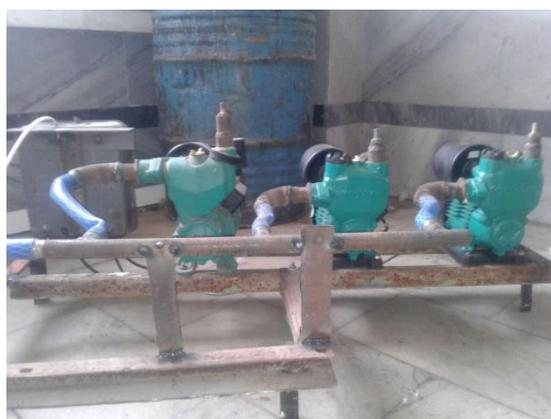
Рисунок 2. Общий вид корпуса и насосов портативного увлажнителя волокна
