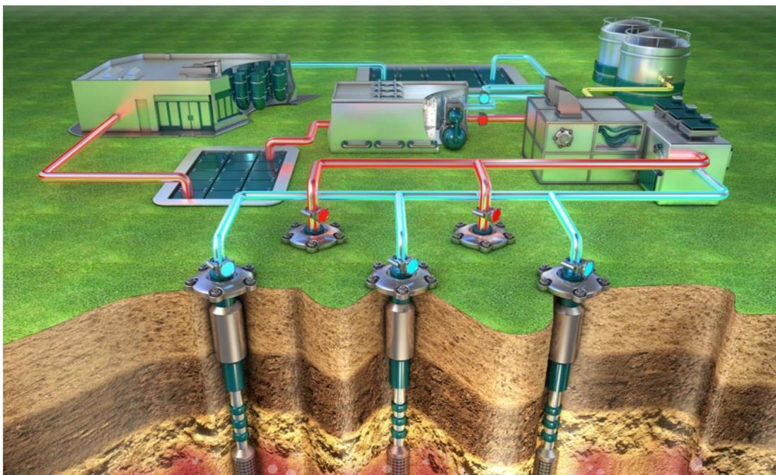
Рисунок 1. Технологический процесс метода подземного скважинного выщелачивания урана [3]
