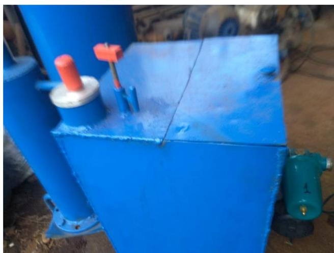
Рисунок 3. Паровой генератор увлажнителя волокна
