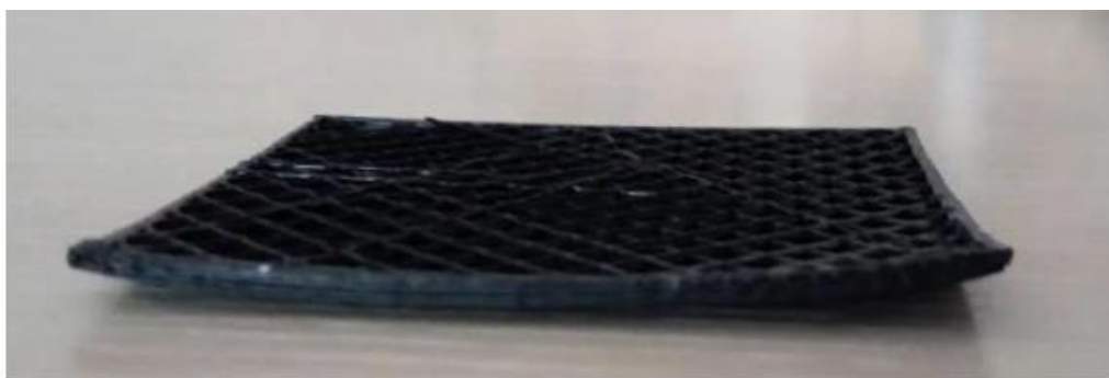
Рисунок 1. Загибание и отслаивание углов у модели
