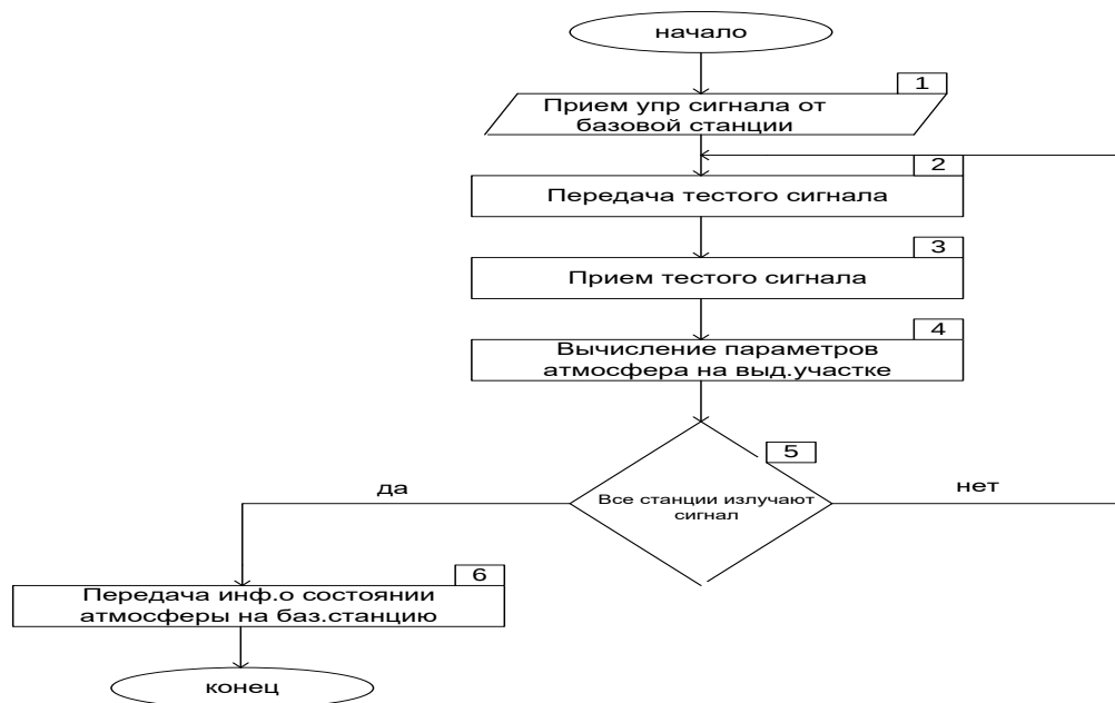
Рисунок 2. Алгоритм работы станции
