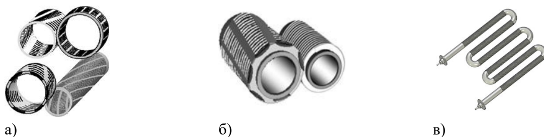
Рис. 1. Детали со сквозной и глухой дискретно- щелевой структурой.
