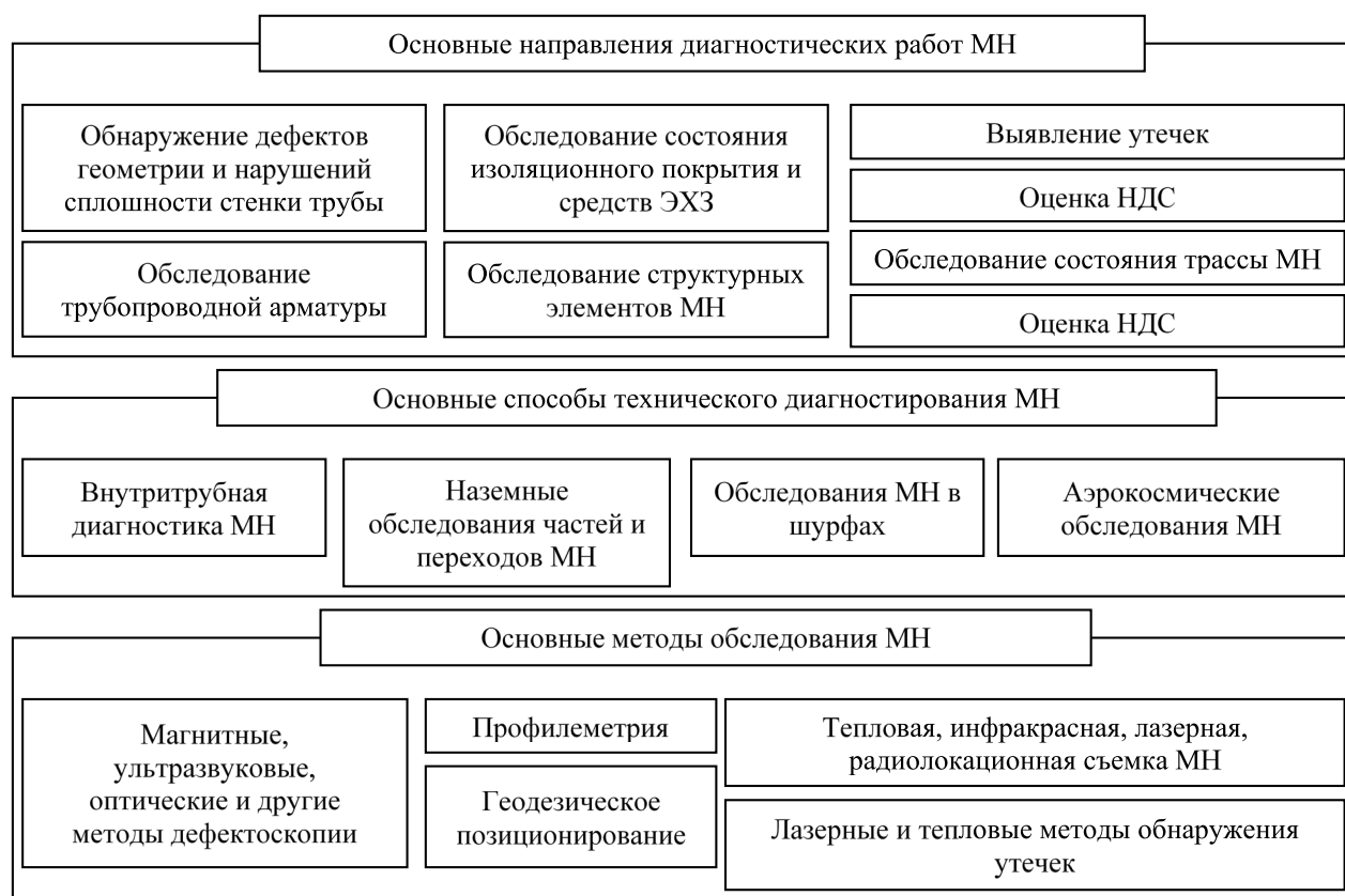
Рисунок 1. Структурная схема комплекса диагностических работ на магистральных нефтепроводах [1-5]
