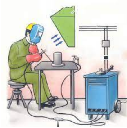
Рис. 1. Визуализация процесса работы за сварочным постом с панелью равномерного всасывания
