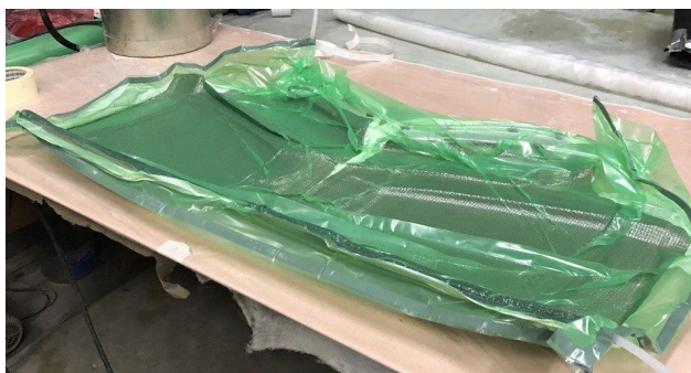
Рис.2. Упакованная в вакуумный пакет деталь, проверка герметичности
