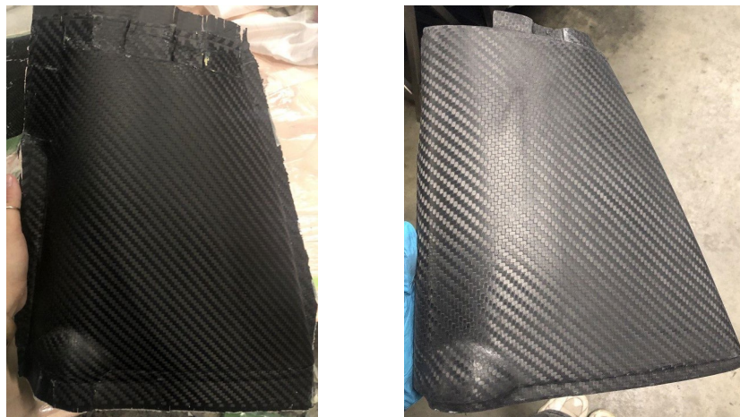
Рис.3. Деталь сразу после формования (слева), деталь после механической обработки (справа)
