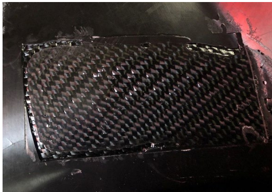
Рис. 1. Заплата с использованием ручного формования с оставшимися воздушными пузырями
