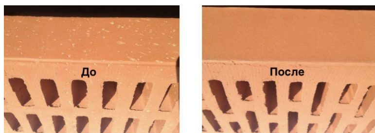
Рисунок 2. Внешний вид лицевого кирпича из глины до и после центробежно-ударного измельчения
