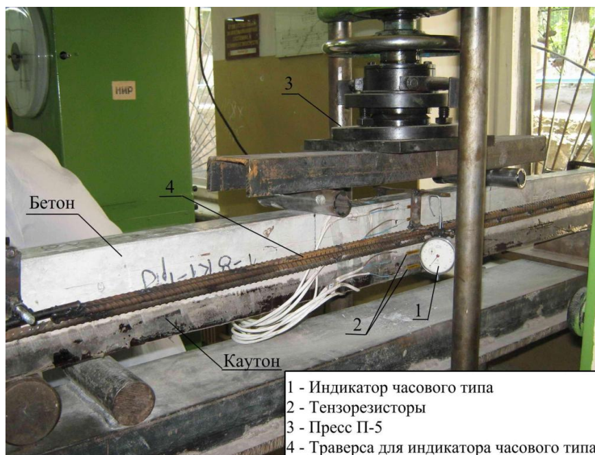
Рисунок 5. - Общий вид испытания двухслойных каутоно-бетонных балок на поперечный изгиб [7, с. 185]
