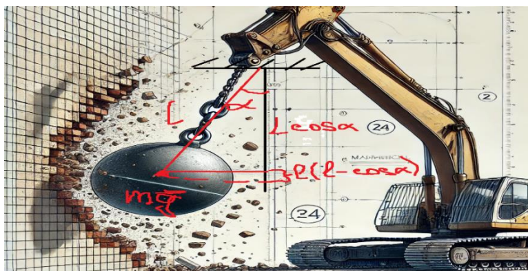
Рис.1 Зарисовка с условиями в момент столкновения шара экскаватора.
