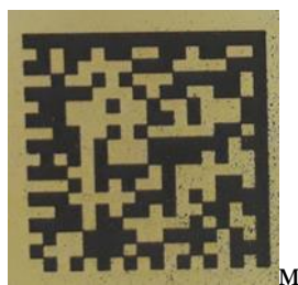
Рисунок 2. Образец металлической шильды из стали 12Х17 после нагрева до 1300 °С
