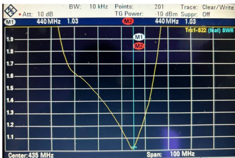
Рисунок 13. Измеренное КСВ на частоте 435 МГц
