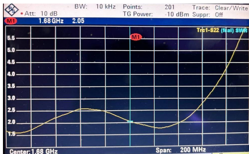
Рисунок 14. КСВ двухчастотной антенны на частоте 1680 МГц
