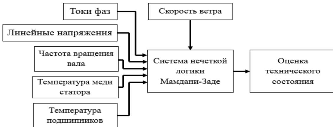
Рис. 2. Структурная схема системы мониторинга технического состояния ветроэнергетической установки
