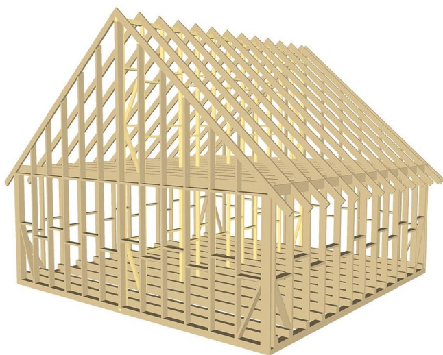
Рисунок 2. Деревянный каркас частного дома
