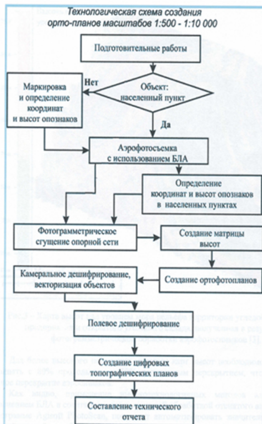
Рисунок 2. Технологическая схема применяемая в ГУП «УзГАШКЛИТИ»
