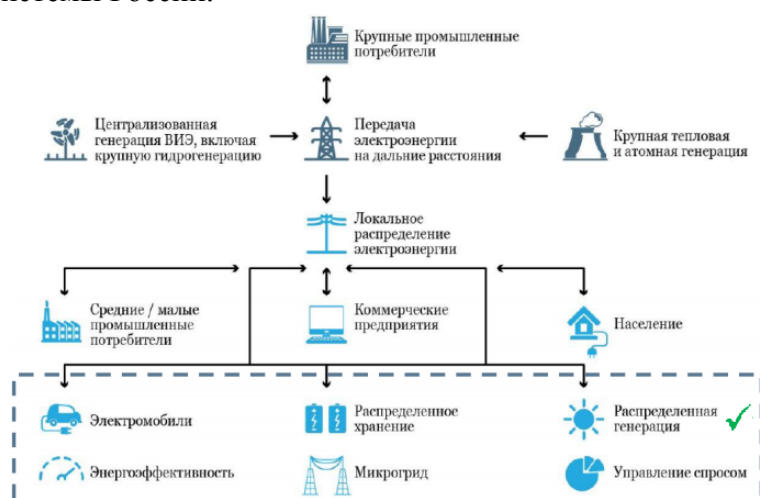
Рисунок 1. Децентрализованная система с активными потребителями
