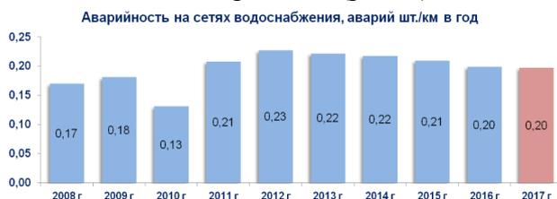
Рисунок 4. Аварийность на сетях водоснабжения ООО «Краснодар Водоканал», количество аварий/км в год, в динамике за 10 лет
