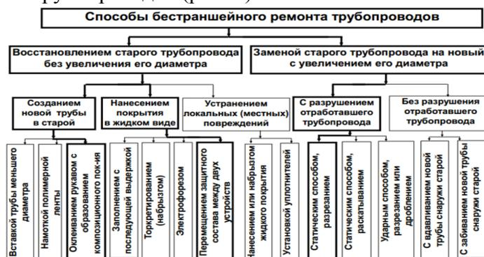
Рисунок 7. Классификация существующих способов бестраншейного ремонта трубопроводов
