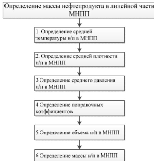
Рисунок 2. Алгоритм расчета массы нефтепродукта в линейной части магистрального нефтепродуктопровода на основании МИ 3275–2010 [3].
