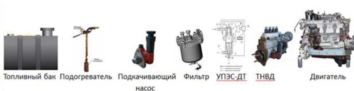
Рис. 1. Схема размещения УПЭС-ДТ в топливной системе двигателя
