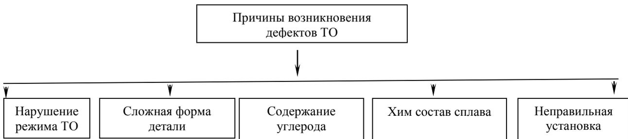
Рисунок 1. Классификация причин возникновения дефектов термической обработки
