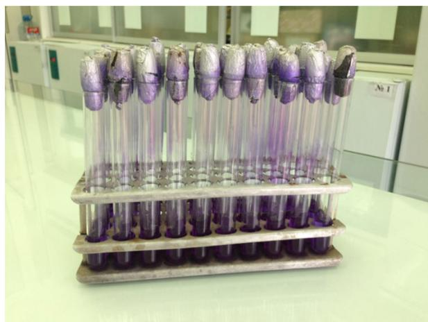
Рисунок 1. Посевы на МПА для определения ОМЧ и на среду Кесслера для определения БГКП
