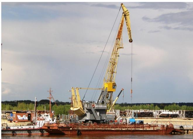
*Рисунок 1. Очистка акватории реки Вычегды на рейде приплава ОАО «Монди Сыктывкарский ЛПК» от разнесенной древесины плавучим краном КПЛ-5-30*
