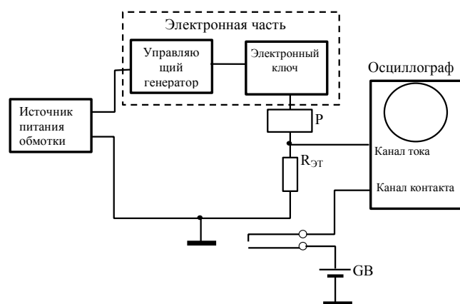
Рисунок 1. Структурная схема лабораторной установки для исследования реле
