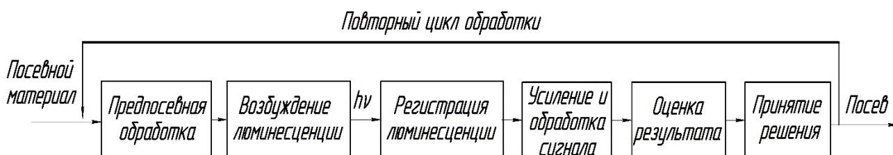
Рисунок 1. Структурная схема методики экспресс-анализа качества скарификации семян кормовых растений
