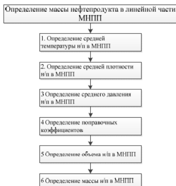
Рисунок 1. Алгоритм расчета массы нефтепродукта в линейной части МНПП согласно МИ 3275–2010 [3].
