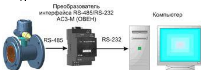
Рисунок 2. Принцип подключения турбинного расходомера
