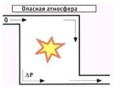
Рисунок 2. Схема оболочки, под повышенном давлении
