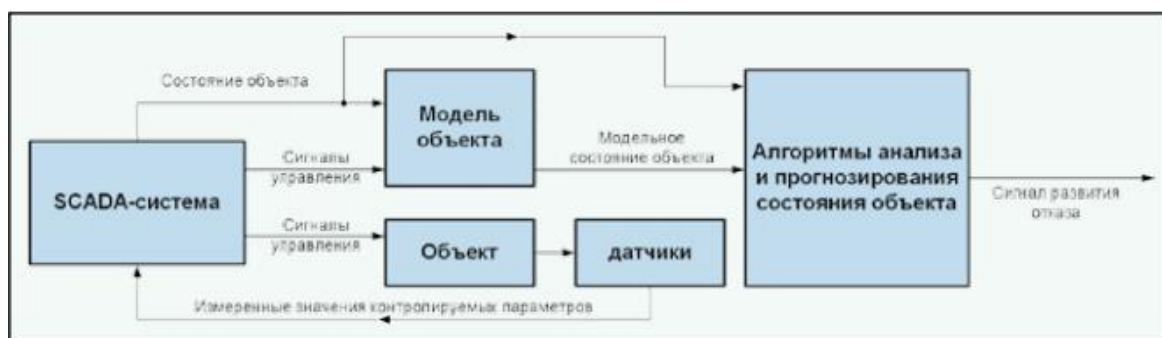
Рисунок 1. Структурная схема SCADA системы
