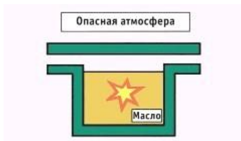
Рисунок 4. Метод защиты погружением в масло
