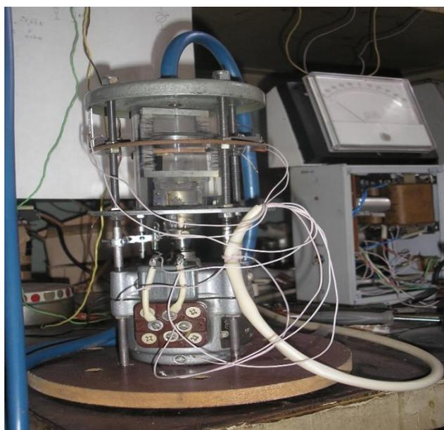
Рисунок 2. Лабораторный измеритель прозрачности воды
