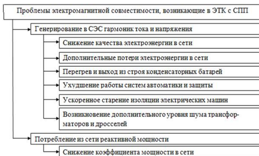
Рисунок 2. Проблемы электромагнитной совместимости СПП с СЭС
