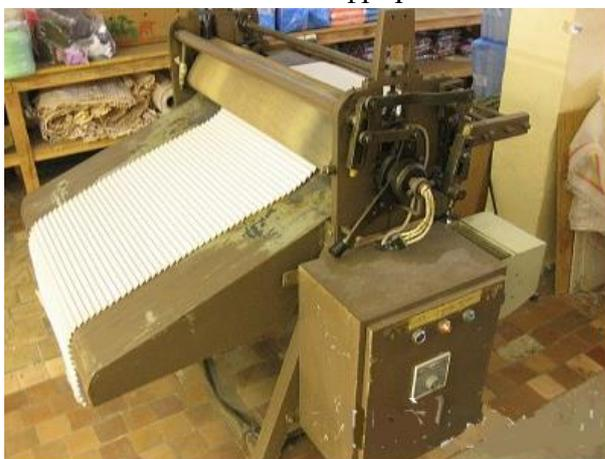
*Рис.1. Двухвалная машина формирующая плесси*
