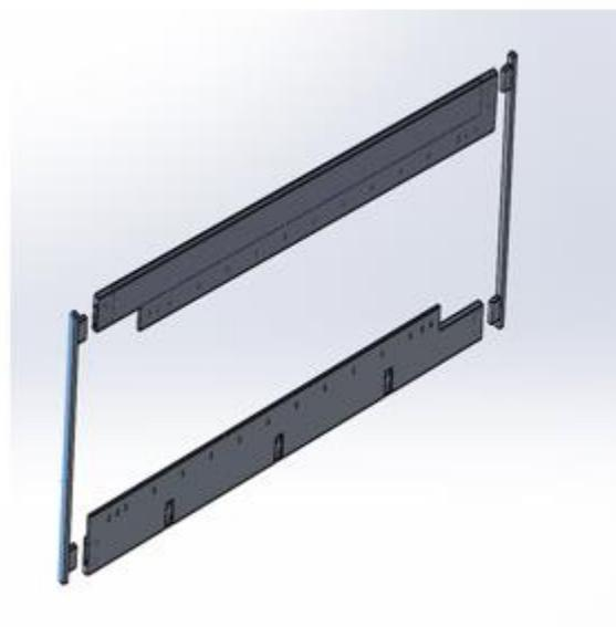
Рисунок 1 – Конструкция ремизной рамы 3д модель
