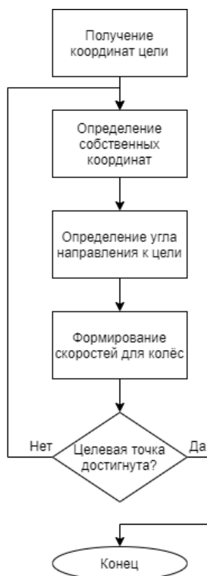
Рис. 2 – Блок-схема базового алгоритма движения к цели
