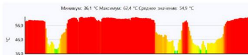
Рисунок 2. Тепловизионное обследование тепловой сети
