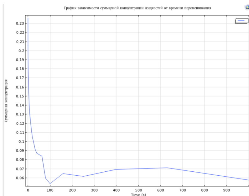
Рисунок 19. График зависимости суммарной концентрации жидкостей от времени перемешивания
