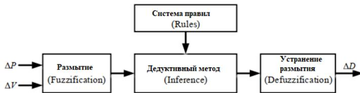
Рис.2. Базовая структура нечеткого контроллера
