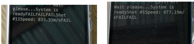
Рис. 7. Значение скорости пули до и после корректировки расстояния между модулями микрофонов
