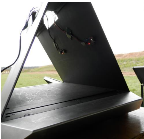
Рис. 5. Размещение модулей микрофонов на корпусе прибора контроля «Баллистика -М»
