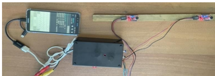
Рис. 4. Акустический прибор для измерения скорости пули
