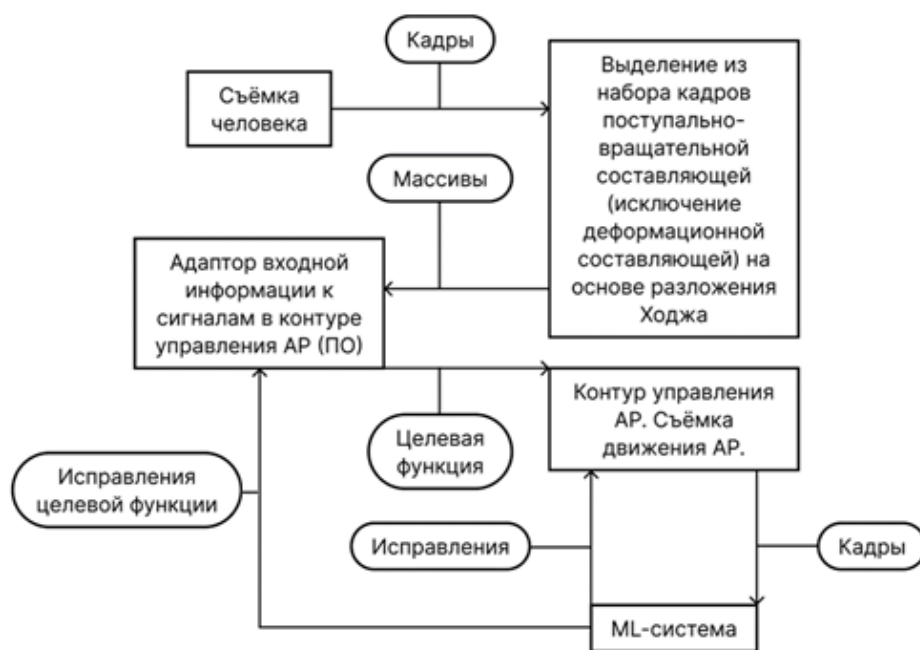
Рисунок 1 – Расширенная посредством включения контура машинного обучения схема алгоритма управления антропоморфного робота (АР)
