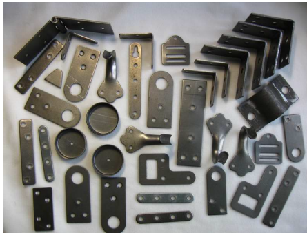
Рисунок 1. Изделия, полученные методом холодной листовой штамповки
